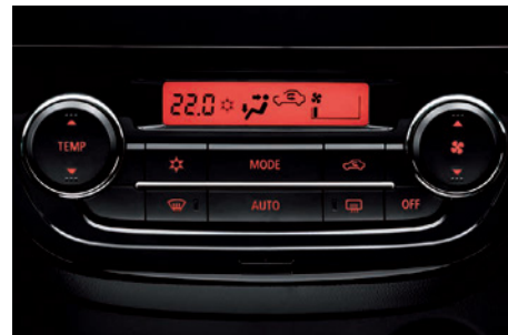
Ar condicionado automático
